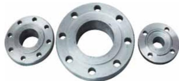
Фланцы предназначены для присоединения запорной, исполнительной и другой арматуры к трубопроводам, а также соединения трубопроводов между собой, включая трубопроводы, на которые распространяются Правила Ростехнадзора, с условным проходом от 20 до 400 мм и условным давлением от 1,6 до 16 МПа. Штамповки фланцев до Ду 150 Ру 4,0 изготавливаются с минимальными припусками для механической обработки. Продолжается совершенствование технологии для изготовления штамповок фланцев и для больших размеров.
