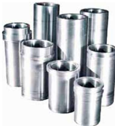
Предназначены для изменения подачи и давления при работе поршней в среде промывочной жидкости. Цилиндровая втулка представляет собой сменный рабочий цилиндр бурового насоса. Рабочая внутренняя поверхность втулок имеет упрочненный слой глубиной не менее 2 мм с твердостью HRC60...64 и зеркальной поверхности 0,8. Материал ст 70 ГОСТ14959-79.
